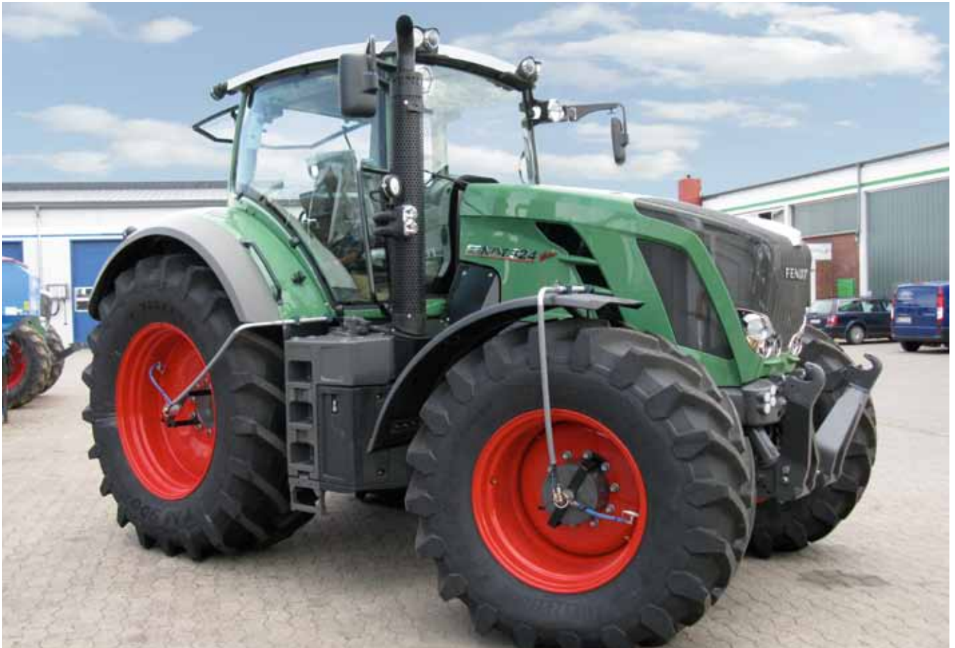
AIRBOX/drive 2L – Fendt Vario 2-Leiter-Reifendruckregelsystem für alle Ackerschlepper
