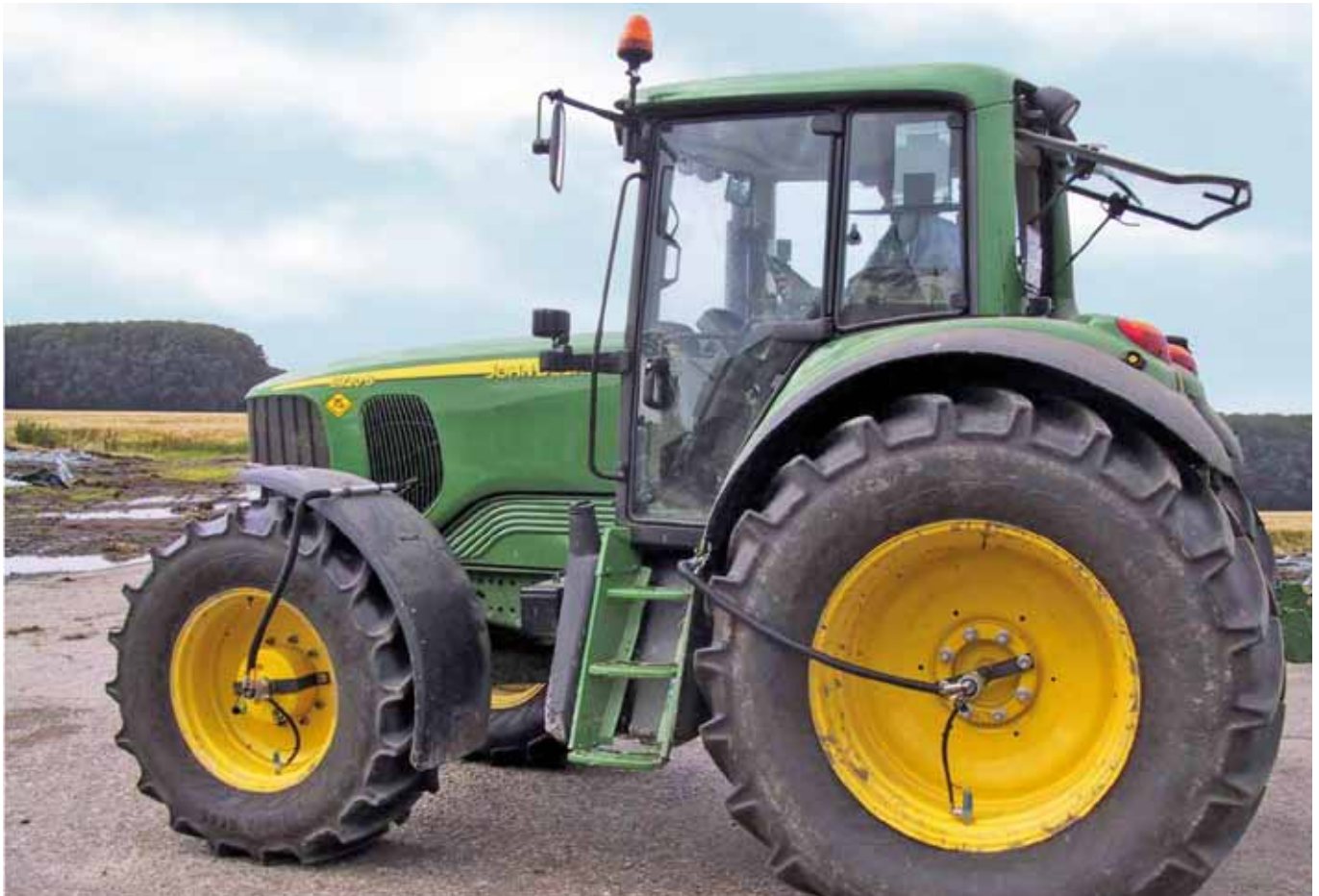
AIRBOX/drive 2L – John Deere 2-Leiter-Reifendruckregelsystem für alle Ackerschlepper
