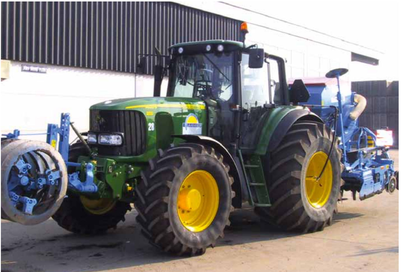
AIRBOX/drive 1L – John Deere 1-Leiter-Reifendruckregelsystem für alle Ackerschlepper
